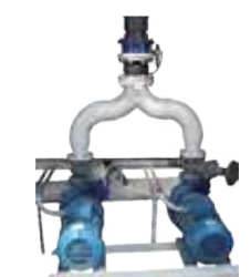
I pompa di rilancio acque decantate bomba de agua limpia clean water pumps
