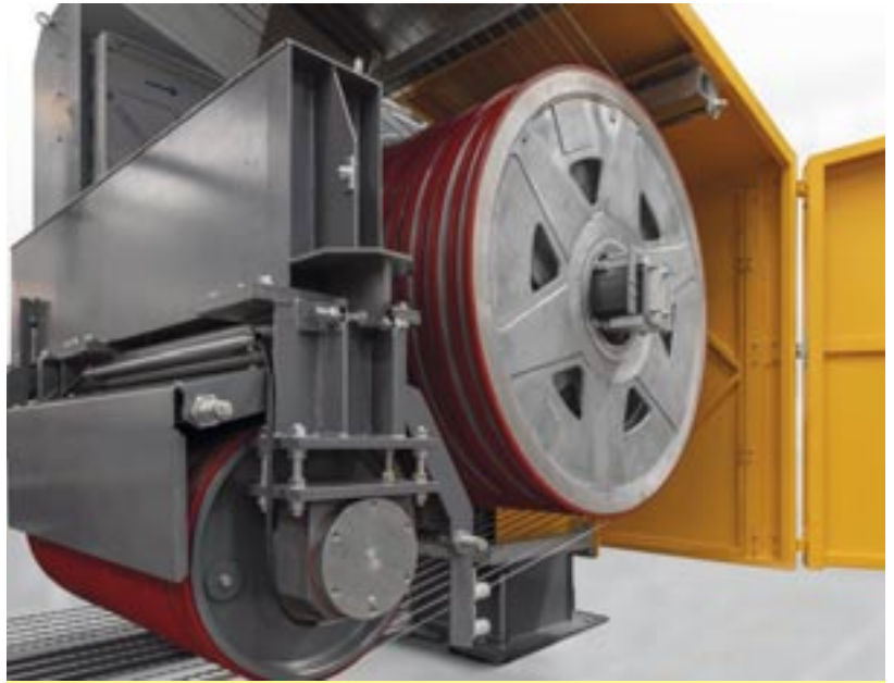
VOLANI LATO TENSIONAMENTO FLYWHEELS TENSIONING SIDE
