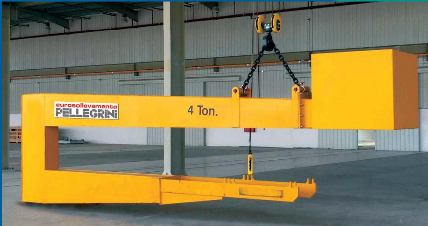
**PORTATA 4 TON.** Struttura in acciaio elettrosaldato e verniciata, con spinotti per l' aggancio di imbracature da applicare ai ganci dei vari tipi di gru. Possibilità di aggancio regolabile ai vari tipi di pacchi di lastre. Questa attrezzatura permette di sollevare e immagazzinare in modo sicuro le lastre nel container sfruttandone tutta la loro capienza.
